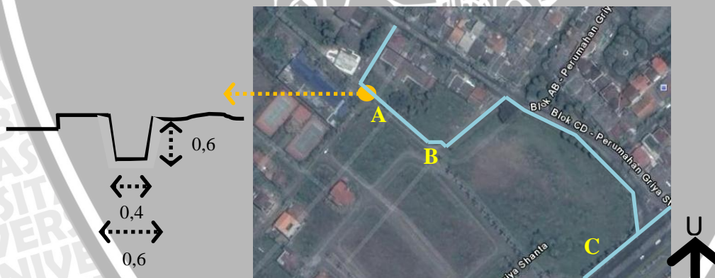
Gambar 4.45. Sistem pembuangan air kotor/drainase tapak
