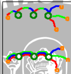
Gambar 2.8 Perbandingan antara multicast (atas) dan unicast (bawah)
