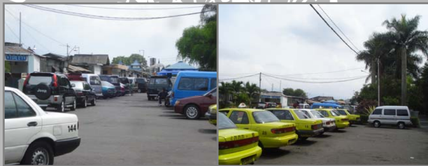
Gambar 2.18. Penataan parkir tegak lurus pada area parkir kendaraan pribadi dan taksi
