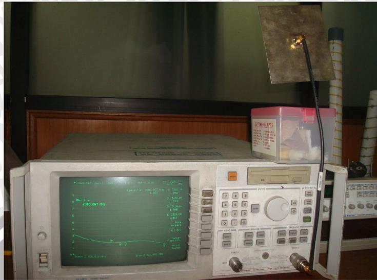
Foto Pengujian VSWR antenna
