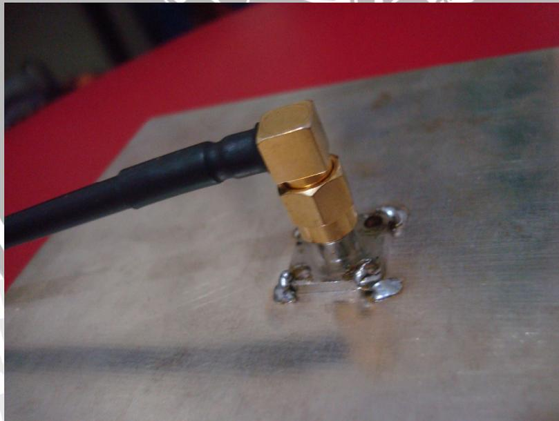
**Foto** Konektor SMA ke *Feed Point*
