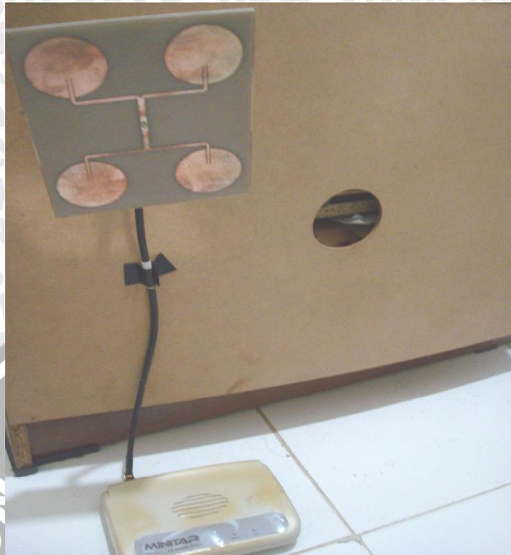
**Foto** Integrasi Antena dengan Access Point
