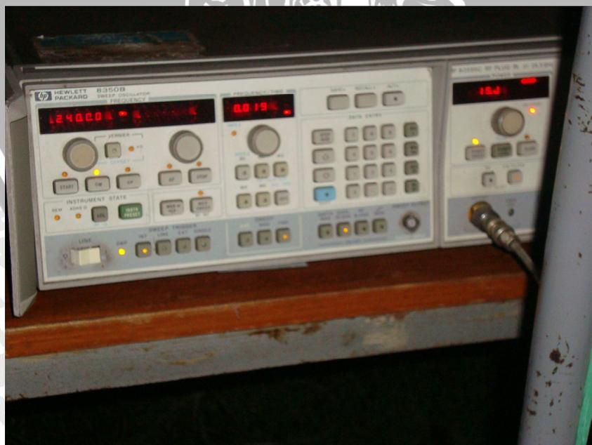
Foto Sweep oscillator 8350 B Hawlett Packard
