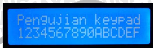
Gambar 5.7. Hasil Pengujian Keypad
