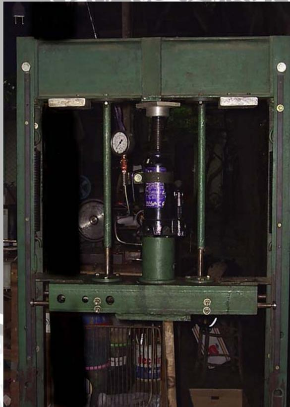
Gambar 3.3. Dongkrak hidrolik
