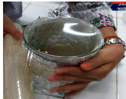
Tutup breaker glas menggunakan plastik warp dan alufo
