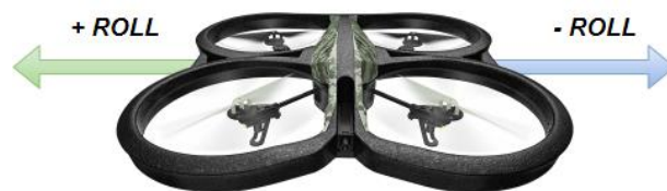
Gambar 2.1 Gerakan Roll Quadcopter
