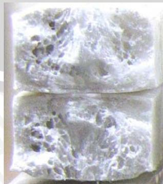
Gambar 4.12 Patahan spesimen uji tarik pada fraksi volume 10%, temperatur 220°C
