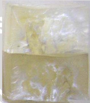
Gambar 4.22 Patahan spesimen uji tarik pada fraksi volume 0%, temperatur 250°C
