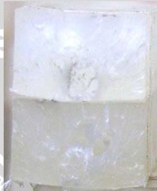
Gambar 4.14 Patahan spesimen uji tarik pada fraksi volume 0%, temperatur 230°C
