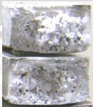
Gambar 4.24 Patahan spesimen uji tarik pada fraksi volume 10%, temperatur 250°C
