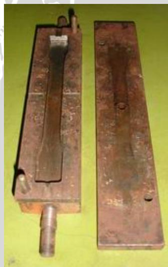
Cetakan Spesimen Uji Tarik
