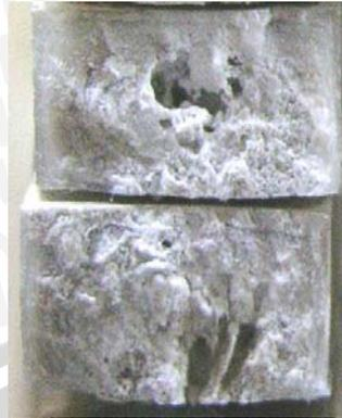
Gambar 4.17 Patahan spesimen uji tarik pada fraksi volume 15%, temperatur 230°C
