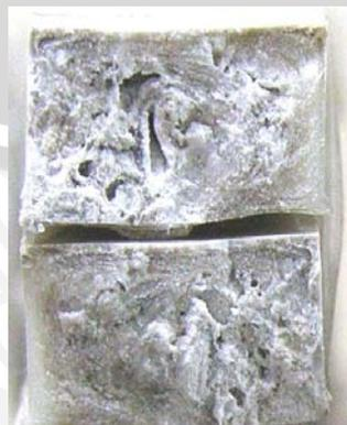
Gambar 4.16 Patahan spesimen uji tarik pada fraksi volume 10%, temperatur 230°C
