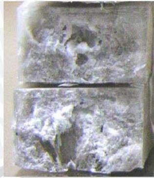
Gambar 4.13 Patahan spesimen uji tarik pada fraksi volume 15%, temperatur 220°C
