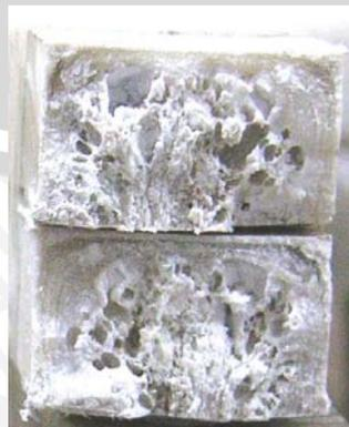
Gambar 4.20 Patahan spesimen uji tarik pada fraksi volume 10%, temperatur 240°C
