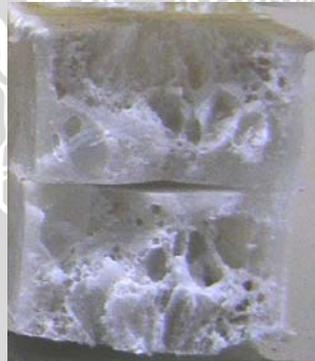
Gambar 4.23 Patahan spesimen uji tarik pada fraksi volume 5%, temperatur 250°C
