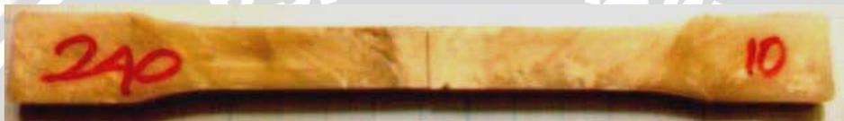
Gambar 4.7 Spesimen uji tarik pada temperatur  $240^\circ\text{C}$  (fraksi volume 10%)
