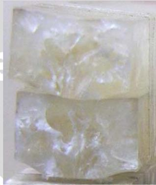
Gambar 4.10 Patahan spesimen uji tarik pada fraksi volume 0%, temperatur 220°C
