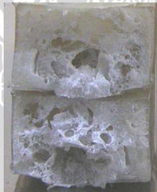
Gambar 4.15 Patahan spesimen uji tarik pada fraksi volume 5%, temperatur 230°C
