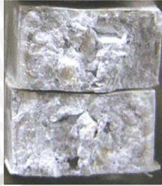
Gambar 4.21 Patahan spesimen uji tarik pada fraksi volume 15%, temperatur 240°C
