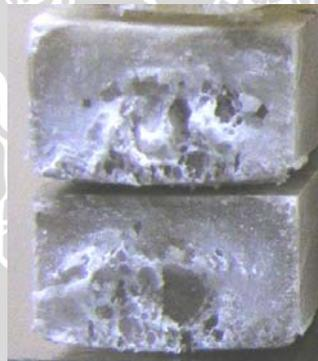
Gambar 4.11 Patahan spesimen uji tarik pada fraksi volume 5%, temperatur 220°C
