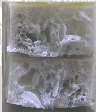
Gambar 4.19 Patahan spesimen uji tarik pada fraksi volume 5%, temperatur 240°C
