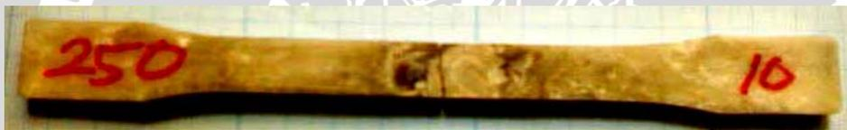
Gambar 4.8 Spesimen uji tarik pada temperatur  $250^\circ\text{C}$  (fraksi volume 10%)
