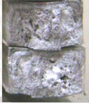
Gambar 4.25 Patahan spesimen uji tarik pada fraksi volume 15%, temperatur 250°C
