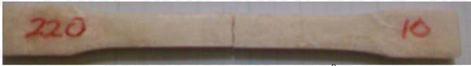
Gambar 4.5 Spesimen uji tarik pada temperatur  $220^\circ\text{C}$  (fraksi volume 10%)
