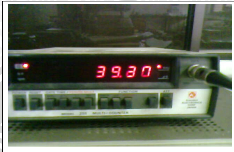
Gambar 5.4. Nilai frekuensi yang diterima oleh transduser ultrasonik
