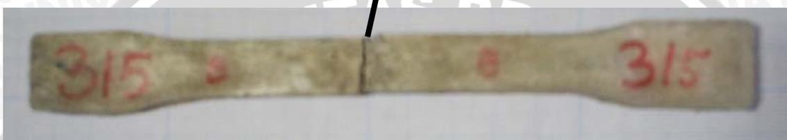
Gambar 4.8 Patahan Spesimen Uji Kekuatan Tarik Ukuran Butir 315 $\mu$ m
