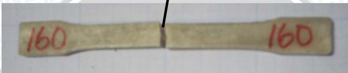
Gambar 4.6 Patahan Spesimen Uji Kekuatan Tarik Ukuran Butir 160µm
