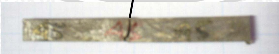
Gambar 4.9 Patahan Spesimen Uji Kekuatan Impak Ukuran Butir 45 $\mu$ m
