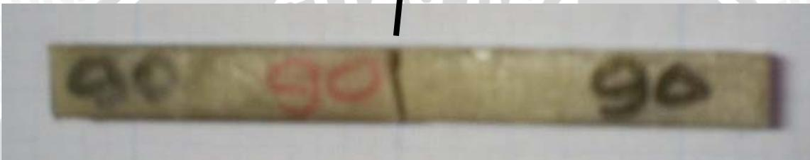
Gambar 4.10 Patahan Spesimen Uji Kekuatan Impak Ukuran Butir 90µm
