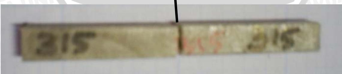
Gambar 4.13 Patahan Spesimen Uji Kekuatan Impak Ukuran Butir 315µm
