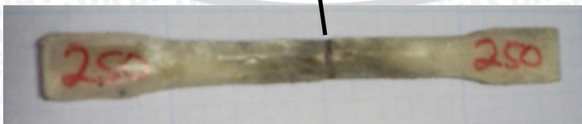
Gambar 4.7 Patahan Spesimen Uji Kekuatan Tarik Ukuran Butir 250µm
