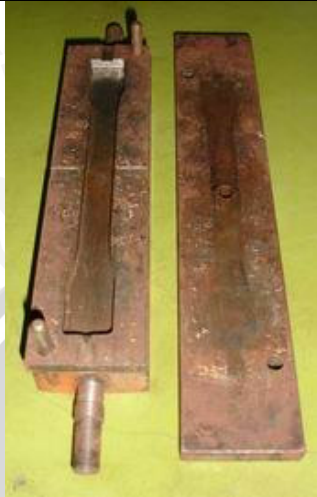
Cetakan Spesimen Uji Tarik
