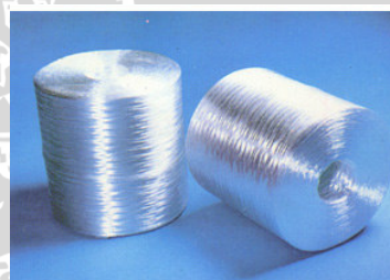
Merk : Chemetals Kekuatan Tarik : 2,2 GPa Densitas : 2,54 g/cm 3
