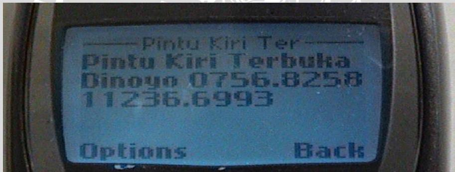
Gambar 5.10 Sensor pintu kiri (limit switch) aktif
