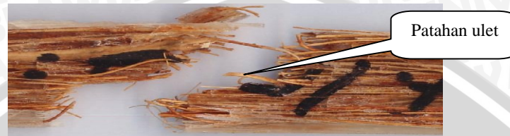
Gambar 4.7 Bentuk patahan spesimen uji tarik komposit hibrid (10% E-Glass :10% Sabut kelapa)
