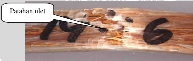
Gambar 4.15 Bentuk patahan spesimen uji impak komposit hibrid (14% E-Glass :6% Sabut kelapa)
