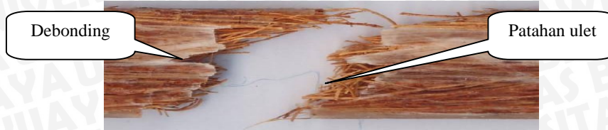
Gambar 4.6 Bentuk patahan spesimen uji tarik komposit hibrid (6% E-Glass :14% Sabut kelapa)
