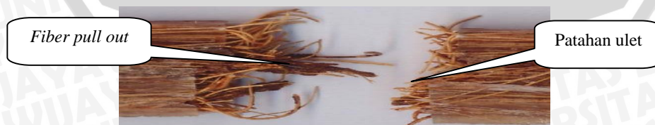
Gambar 4.5 Bentuk patahan spesimen uji tarik komposit hibrid (2% E-Glass:18% Sabut kelapa)
