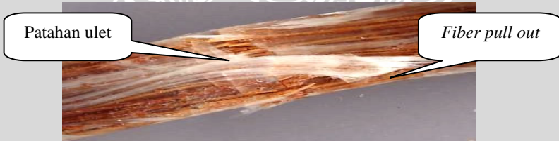
Gambar 4.14 Bentuk patahan spesimen uji impak komposit hibrid (10% E-Glass :10% Sabut kelapa)
