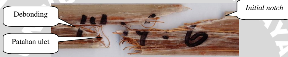
Gambar 4.8 Bentuk patahan spesimen uji tarik komposit hibrid (14% E-Glass :6% Sabut kelapa)
