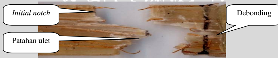
Gambar 4.9 Bentuk patahan spesimen uji tarik komposit hibrid (18% E-Glass :2% Sabut kelapa)
