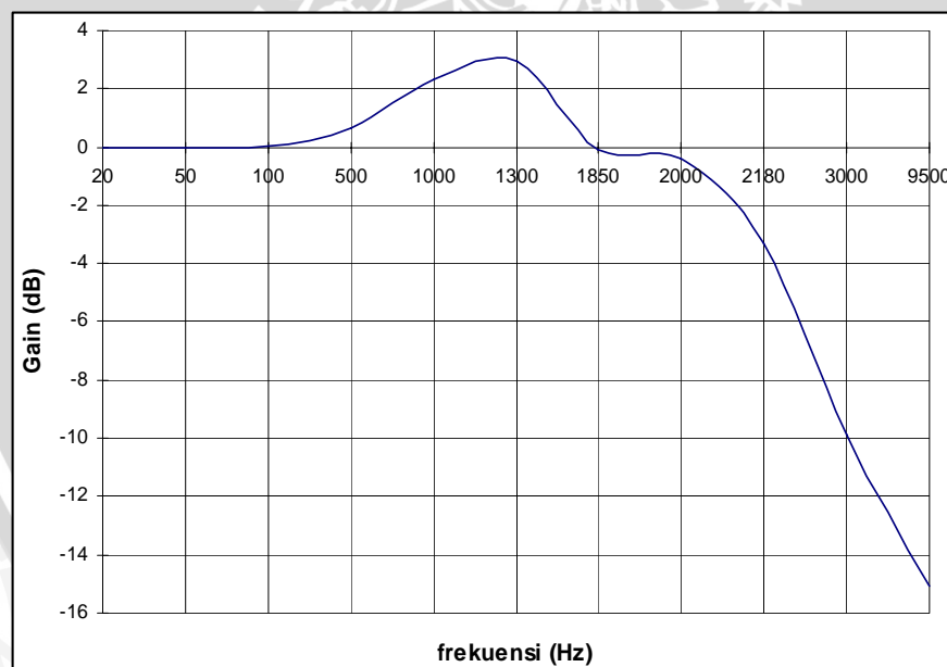
Gambar 4.5. Tanggapan frekuensi Rangkaian Filter aktif low pass orde dua
