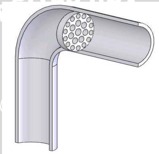
Gambar 3.1 : Plat perforasi pada belokan pipa
