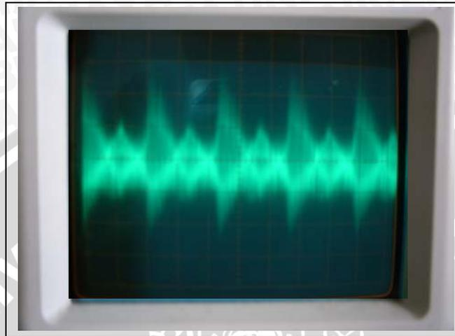
**Gambar 5.11.** Output modulator *frequency hopping* dengan  $\text{time/div}=2\text{ms}$  dan  $\text{V/div}=0,1\text{V}$
