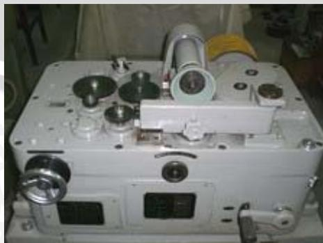
Gambar 3.6 Mesin uji ketahanan aus
