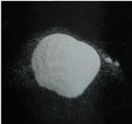
$\text{Al}_2\text{O}_3$  100  $\mu\text{m}$
