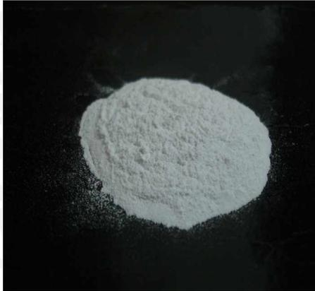
$\text{Al}_2\text{O}_3$  63  $\mu\text{m}$
