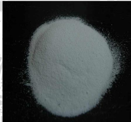
$\text{Al}_2\text{O}_3$  125  $\mu\text{m}$
