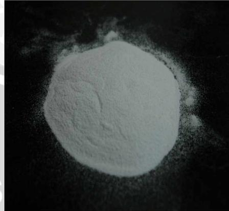
$\text{Al}_2\text{O}_3$  80  $\mu\text{m}$
