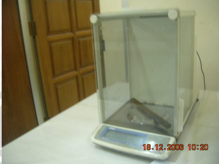
Penimbangan Spesimen Uji Korosi pada Timbangan Digital
