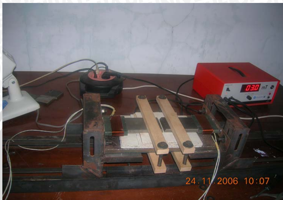
Pengujian Besar Induksi Magnet dengan Teslameter
