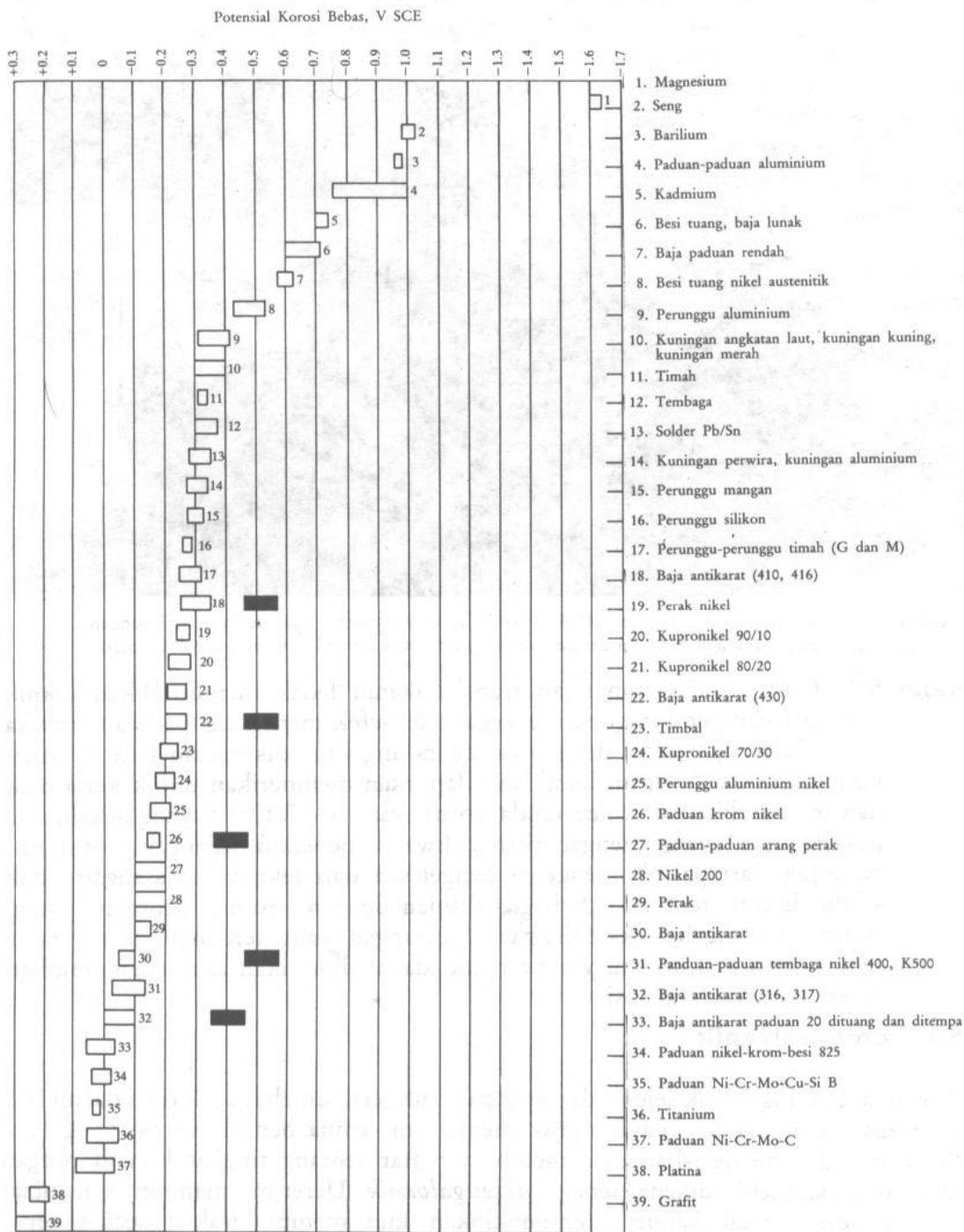
Gambar 2.19 Korosi Kontak Sumber: Chamberlain, 1994:114
