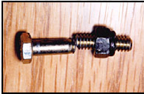
Gambar 2.17 Korosi Lelah Menyebabkan Poros Patah
