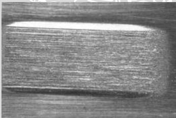
Gambar 2 : Kerusakan Setelah Pengujian Keausan
