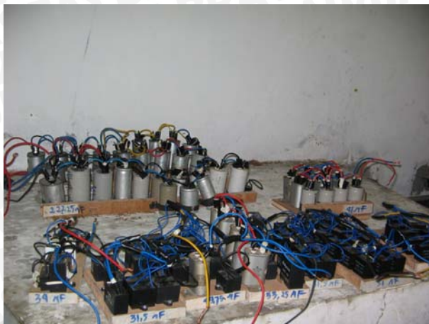
Gambar L-7.4. Kapasitor eksitasi generator induksi
