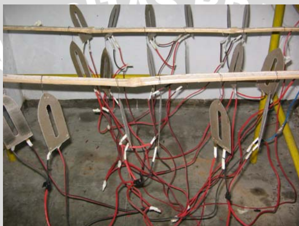
Gambar L-7.5. Beban resistif berupa elemen setrika
