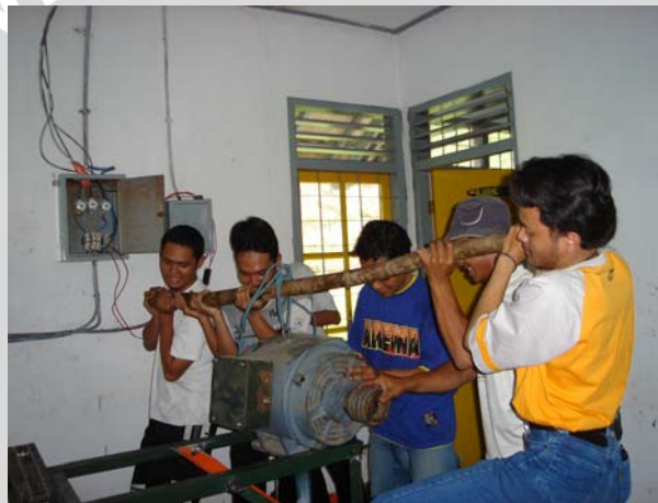
Gambar L-7.2. Pemasangan generator induksi pada casis
