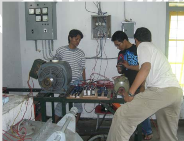
Gambar L-7.8. Pengujian pengoperasian mesin induksi 3 kW sebagai generator induksi yang diparalel dengan generator sinkron 15 kVA
