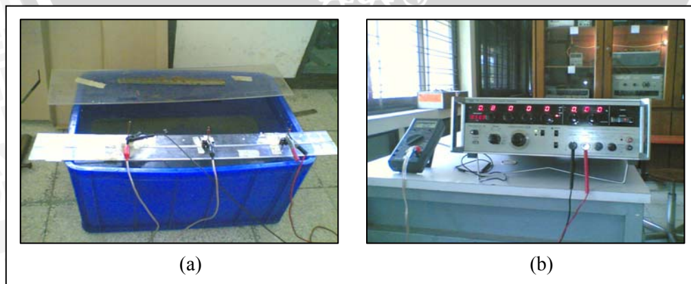
Gambar 3.2 (a) Obyek uji dan media tanam; (b) Alat ukur (sumber arus AC dan voltmeter)
