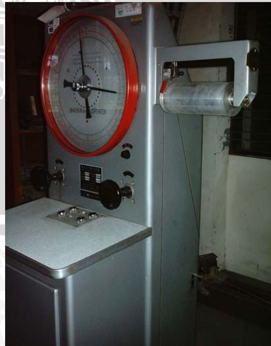
Alat pembaca pada uji tarik baja
