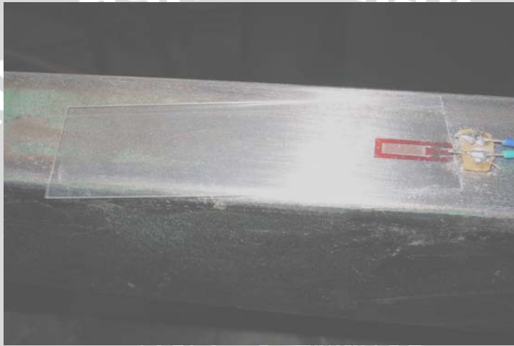
Pemasangan straingauge pada batang lemah
