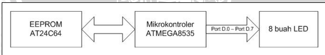
Gambar 5.7 Diagram Blok Pembacaan Data dari EEPROM AT24C64
