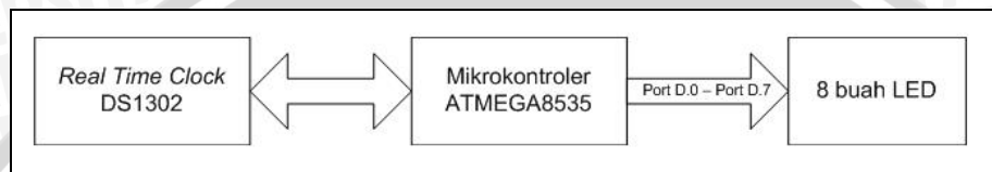
Gambar 5.4 Diagram Blok Pengujian RTC DS1302
