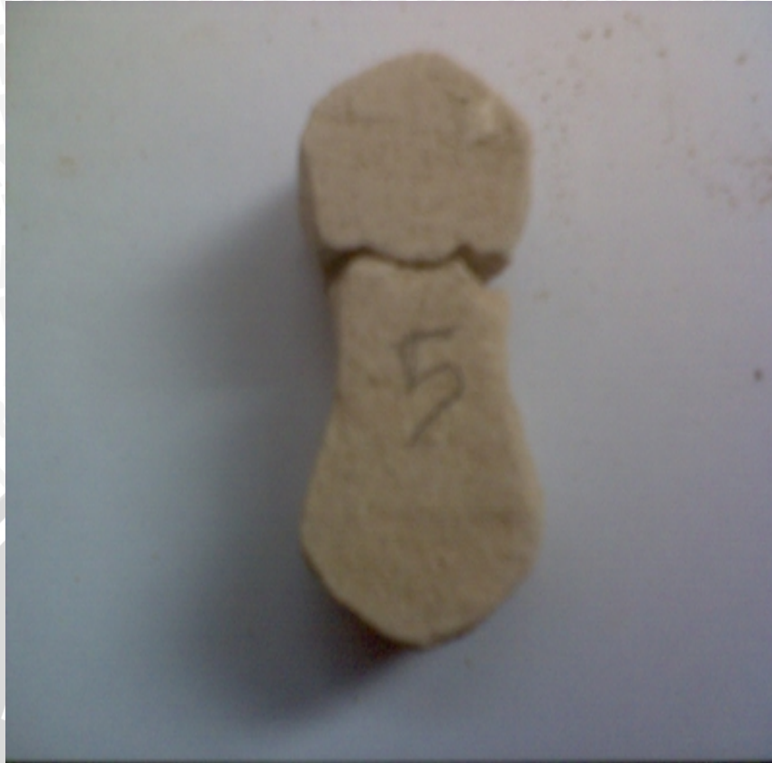
Specimen uji Tarik dengan komposisi feldspar 40 gr
