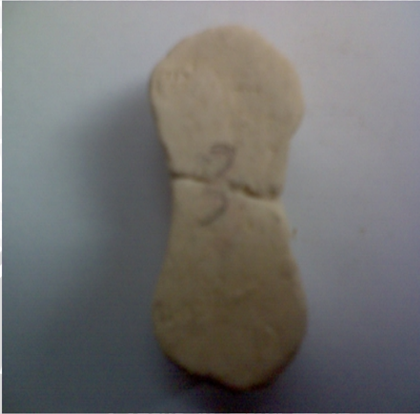
Specimen uji Tarik dengan komposisi feldspar 30 gr
