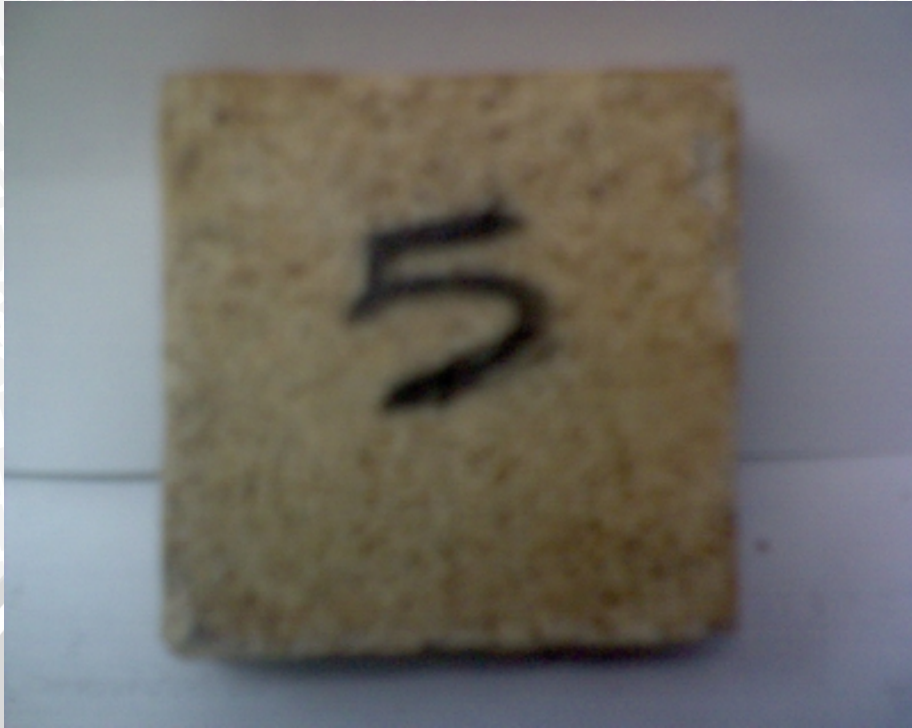
Specimen uji Kekerasan dengan komposisi feldspar 40 gr
