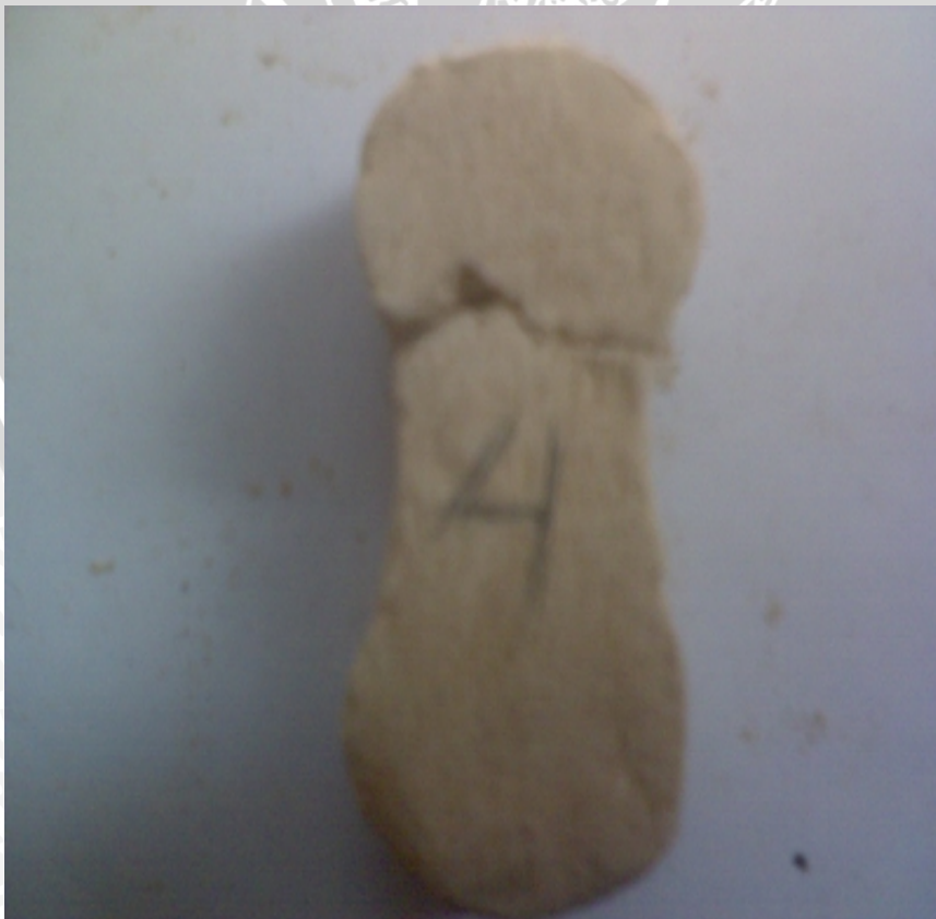
Specimen uji Tarik dengan komposisi feldspar 35 gr
