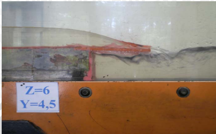
Gambar B.15. Foto Pengaliran Pada Terjunan Tegak Berkisi Peredam (8 cm) Dengan Tinggi Muka Air Hulu ( Y_o = 4,5\text{cm} ) dan Tinggi Terjunan ( Z = 6\text{ cm} ).
