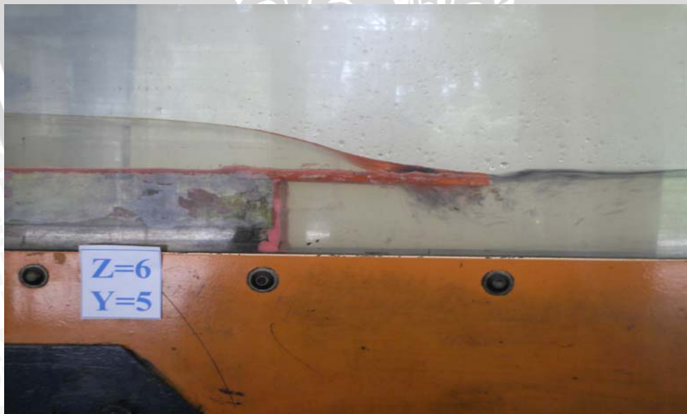
Gambar B.12. Foto Pengaliran Pada Terjunan Tegak Berkisi Peredam (12 cm) Dengan Tinggi Muka Air Hulu ( Y_o = 5 cm) dan Tinggi Terjunan ( Z = 6 cm).
