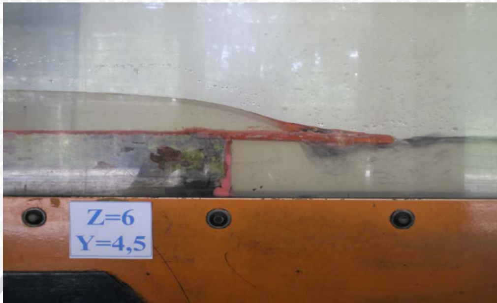
Gambar B.11. Foto Pengaliran Pada Terjunan Tegak Berkisi Peredam (12 cm) Dengan Tinggi Muka Air Hulu ( Y_o = 4,5 cm) dan Tinggi Terjunan ( Z = 6 cm).
