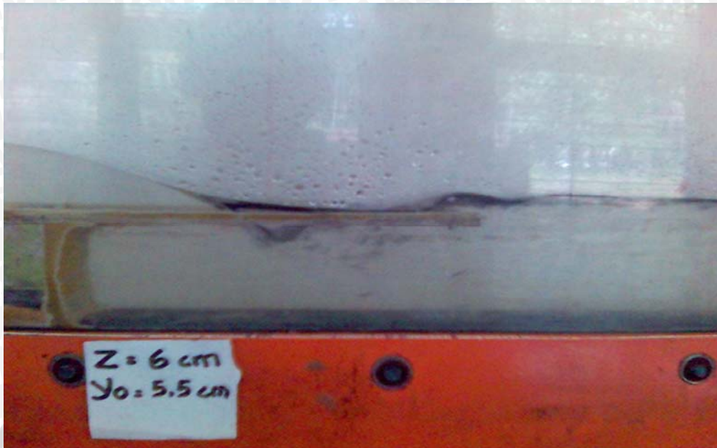
Gambar B.9. Foto Pengaliran Pada Terjunan Tegak Berkisi Peredam (18 cm) Dengan Tinggi Muka Air Hulu ( Y_o = 5,5 cm) dan Tinggi Terjunan ( Z = 6 cm).
