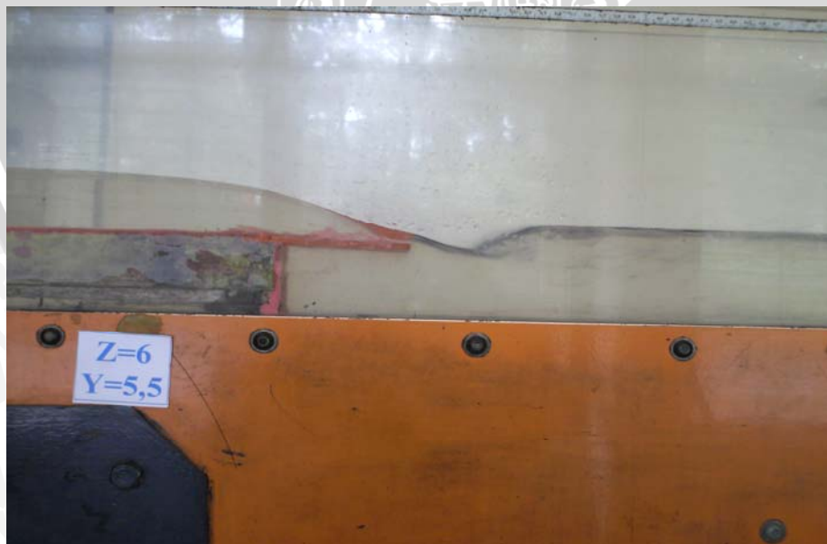
Gambar B.16. Foto Pengaliran Pada Terjunan Tegak Berkisi Peredam (8 cm) Dengan Tinggi Muka Air Hulu ( Y_o = 5,5\text{cm} ) dan Tinggi Terjunan ( Z = 6\text{ cm} ).
