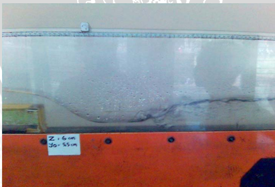
Gambar B.6. Foto Pengaliran Pada Terjunan Tegak Dengan Tinggi Muka Air Hulu ( Y_o = 5,5 cm) dan Tinggi Terjunan ( Z = 6 cm ).
