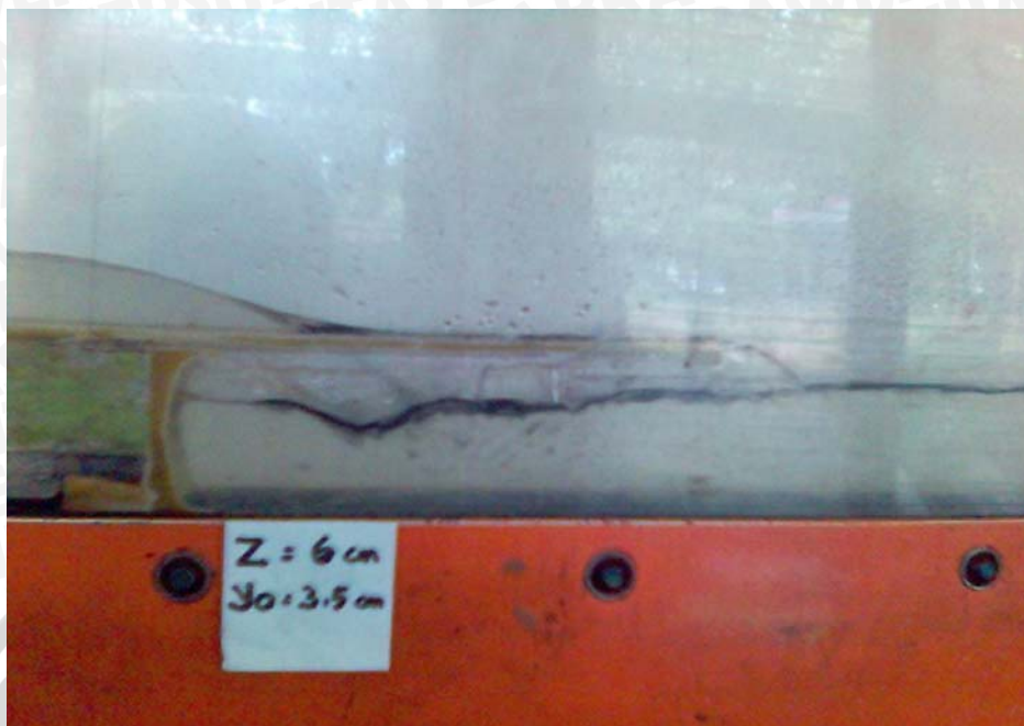
Gambar B.7. Foto Pengaliran Pada Terjunan Tegak Berkisi Peredam (18 cm) Dengan Tinggi Muka Air Hulu ( Y_o = 3,5 cm) dan Tinggi Terjunan ( Z = 6 cm ).
