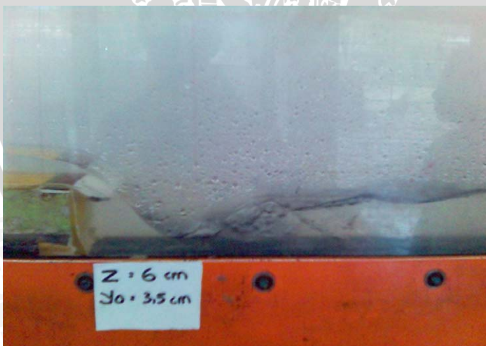
Gambar B.4. Foto Pengaliran Pada Terjunan Tegak Dengan Tinggi Muka Air Hulu ( Y_o = 3,5 cm) dan Tinggi Terjunan ( Z = 6 cm ).
