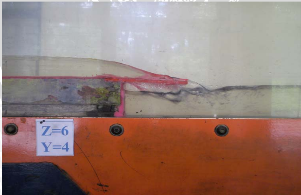
Gambar B.14 Foto Pengaliran Pada Terjunan Tegak Berkisi Peredam (8 cm) Dengan Tinggi Muka Air Hulu ( Y_o = 4 cm) dan Tinggi Terjunan ( Z = 6 cm).
