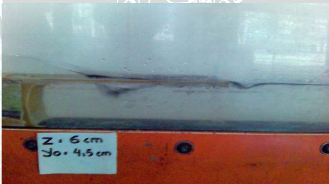
Gambar B.8. Foto Pengaliran Pada Terjunan Tegak Berkisi Peredam (18 cm) Dengan Tinggi Muka Air Hulu ( Y_o = 4,5 cm) dan Tinggi Terjunan ( Z = 6 cm ).
