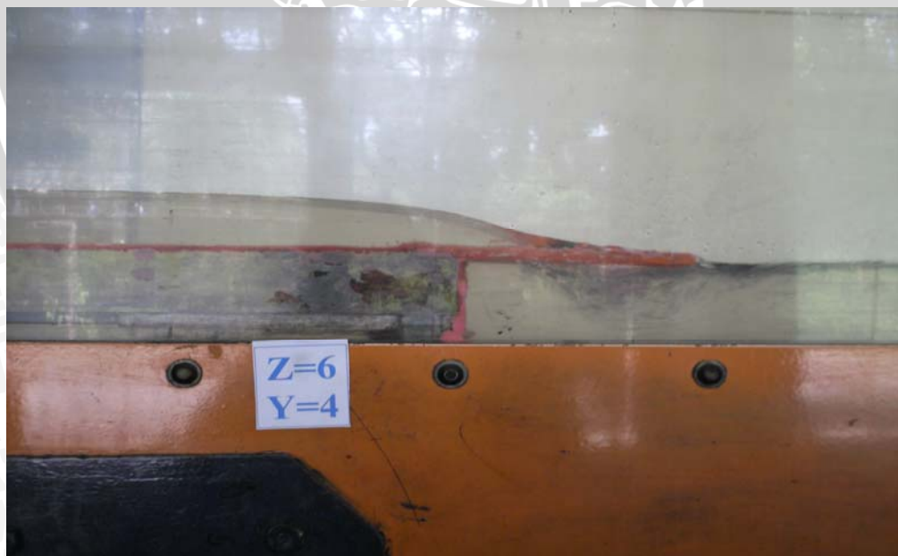
Gambar B.10. Foto Pengaliran Pada Terjunan Tegak Berkisi Peredam (12 cm) Dengan Tinggi Muka Air Hulu ( Y_o = 4 cm) dan Tinggi Terjunan ( Z = 6 cm).
