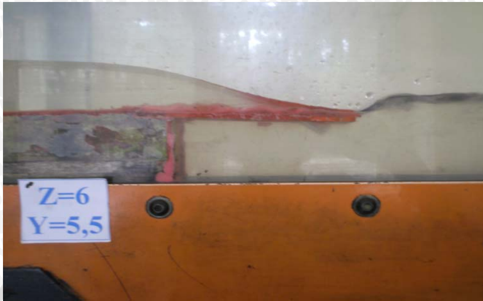
Gambar B.13. Foto Pengaliran Pada Terjunan Tegak Berkisi Peredam (12 cm) Dengan Tinggi Muka Air Hulu ( Y_o = 5,5 cm) dan Tinggi Terjunan ( Z = 6 cm).
