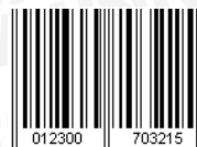
Gambar 2.18 Barcode tipe UPC Sumber: [IND-03]
