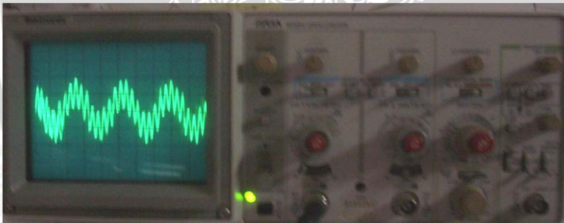
Gambar 5.18 Sinyal suara sebelum alat terpasang saat dial tone kondisi off hook
