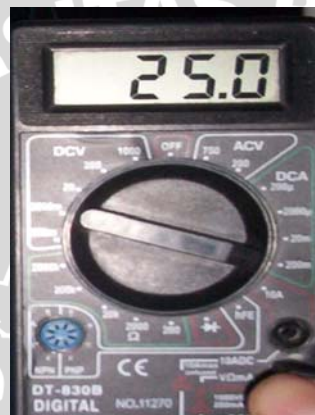
Gambar 5.13 Hasil pengujian Arus sebelum dipasang rangkaian kunci pada saat off hook
