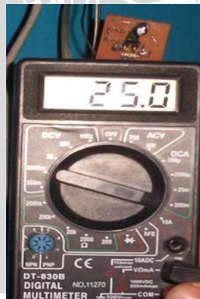
Gambar 5.14 Hasil pengujian Arus line telepon Sesudah rangkaian kunci terpasang saat off hook setelah ada dering
