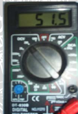
Gambar 5.5. Tegangan zener saat mendeteksi ada dering
