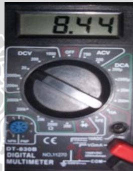
Gambar.5.16 Hasil pengujian tegangan Sesudah terpasang rangkaian kunci saat off hook setelah ada dering
