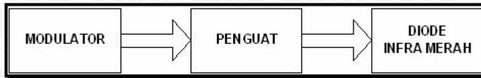
Gambar 4.4. Blok diagram pemancar Sumber: perencanaan
