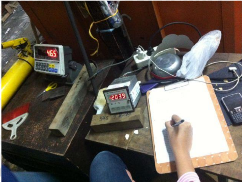
(5) Pencatatan data dari load cell dan lvdt digital
