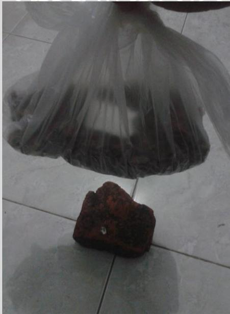
Gambar jatuhnya pelet pada proses durability index
