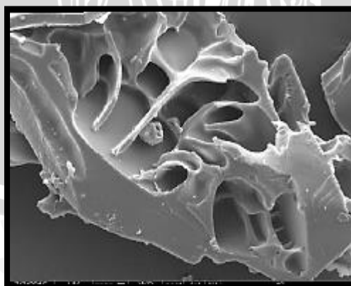
Gambar 9. Struktur enkapsulat ekstrak kasar teh daun alga coklat S. cristaefolium menggunakan penyalut kitosan dan maltodekstrin setelah proses freeze drying perbesaran 2500 kali Sumber : Nursiamah, 2015.
