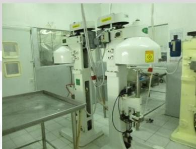
Gambar 14. Mesin Seamer.
