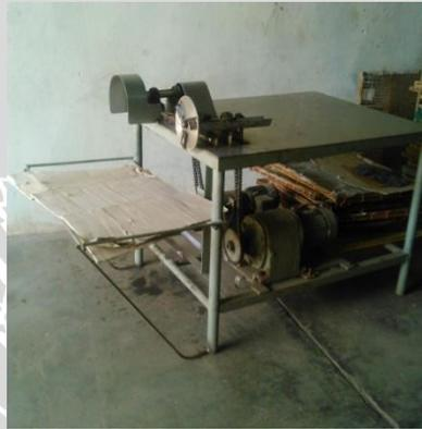
**Gambar 13. Mesin Pengiris Mekanik**
