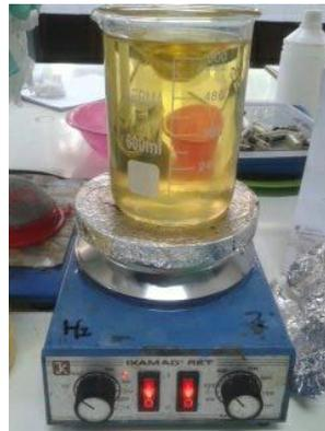
**Tahap 9.** Biodiesel dipanaskan lagi selama 30 menit untuk mengurangi kadar air
