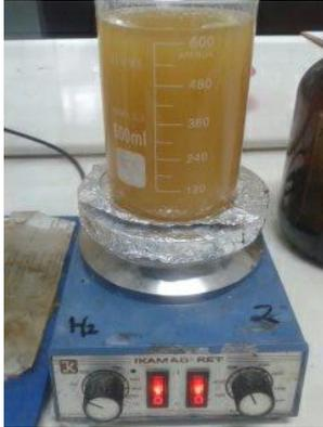
**Tahap 1.** Minyak jelantah yang sudah diberi KOH dan methanol dipanaskan dengan suhu 50°C selama 1 jam
