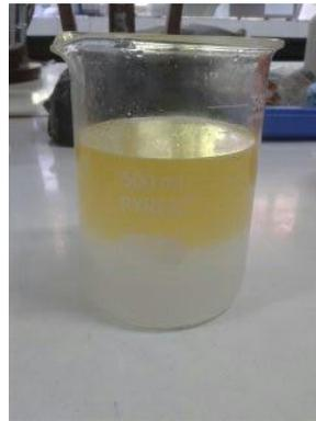
**Tahap 7.** Setelah didiamkan 24 jam didiamkan, terbentuk lapisan sabun (bawah) dan biodiesel (atas)
