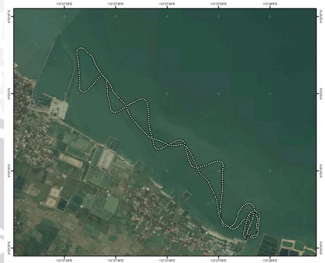
Gambar 4. Jalur dalam melakukan pengambilan data batimetri (*sounding*)
