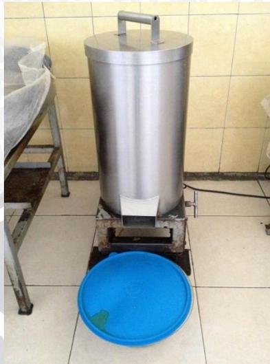
**Gambar 41. Proses Keripik Sirip Ikan Lele di Spinner**
