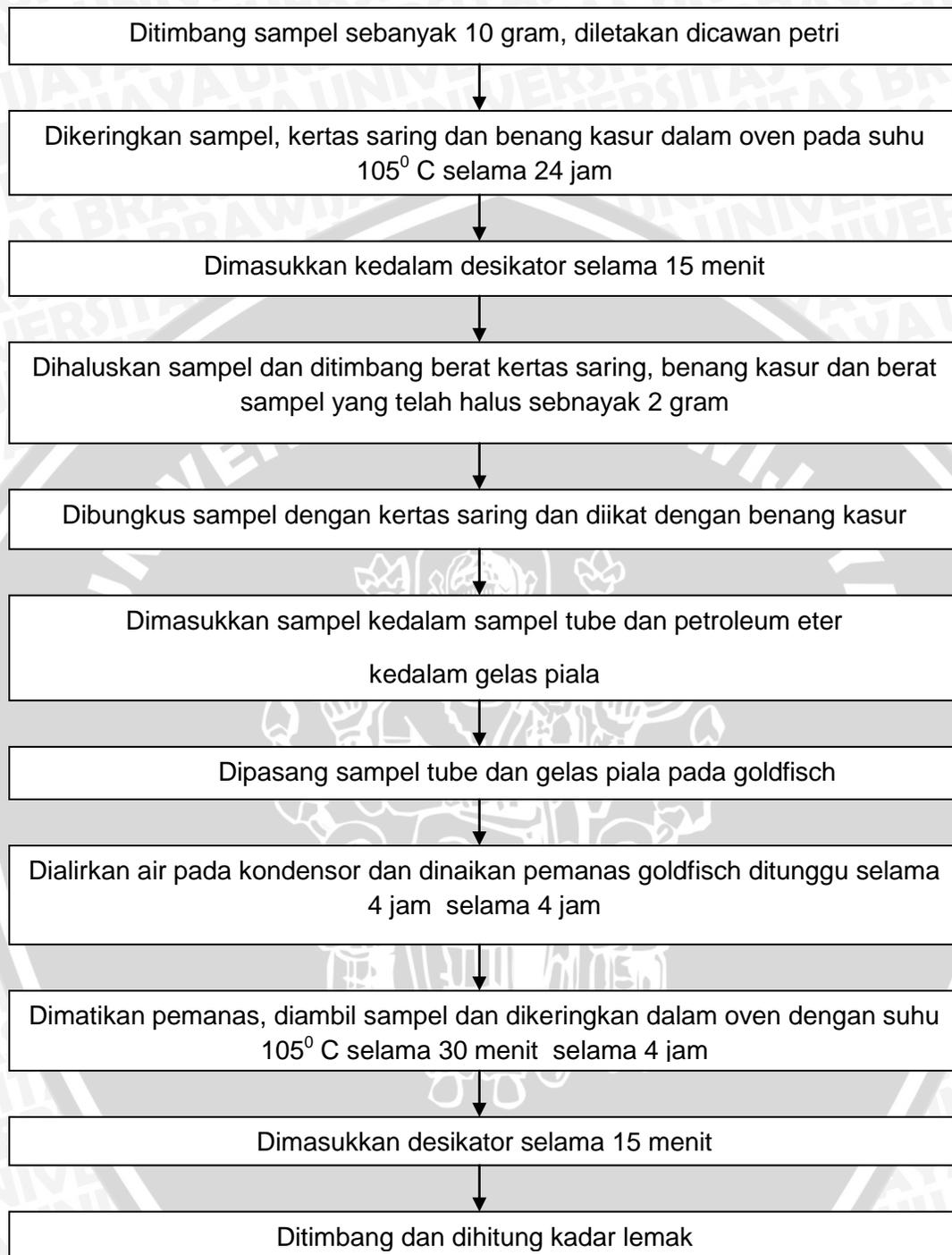
**Gambar 49. Skema Kerja Kadar Lemak**
