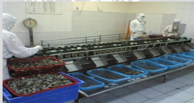
**Gambar 44.** Sortasi menggunakan *grading machine*
