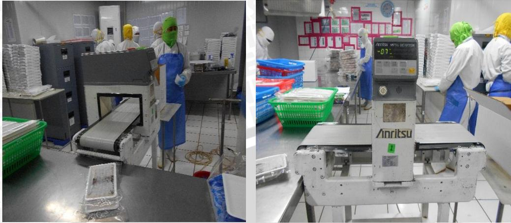
**Gambar 60.** Proses identifikasi logam
