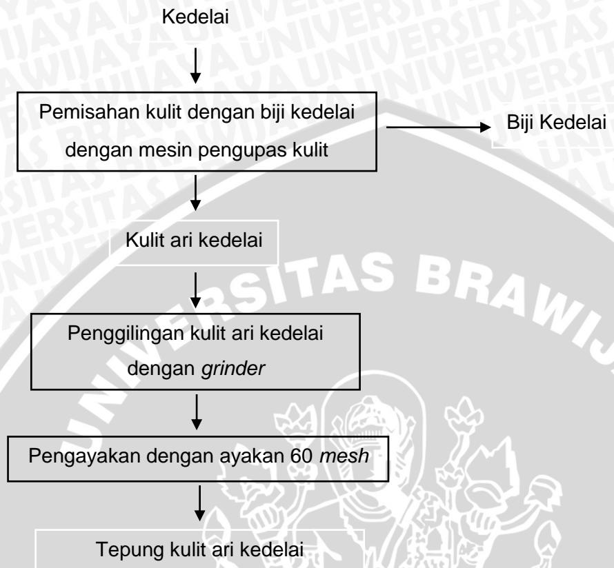
**Gambar 3.** Diagram Alir Pembuatan Tepung Kulit Ari Kedelai
