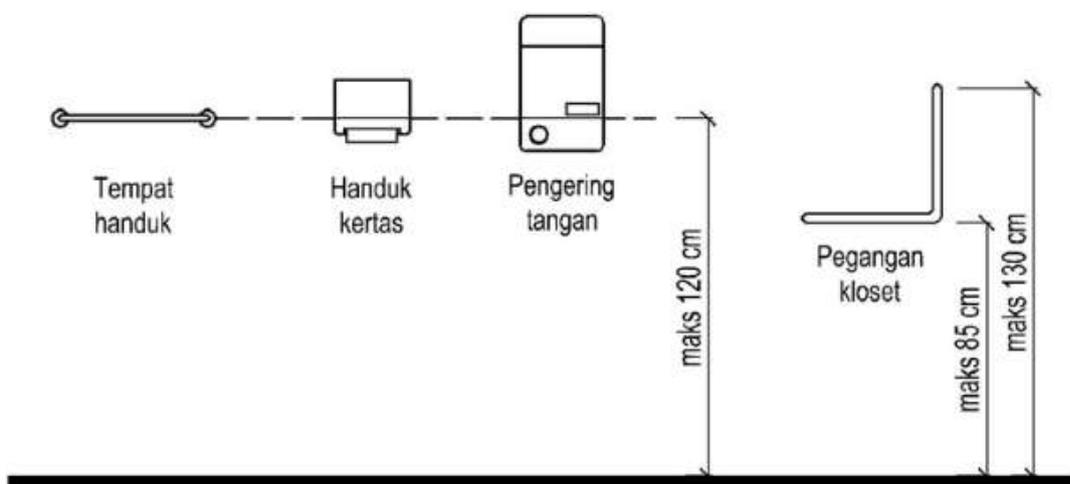
Gambar 17. ukuran untuk peralatan toilet
