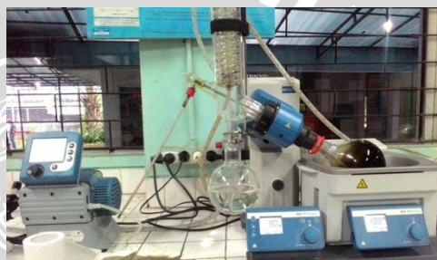
Evaporasi pada suhu \pm 45^{\circ}\text{C}
