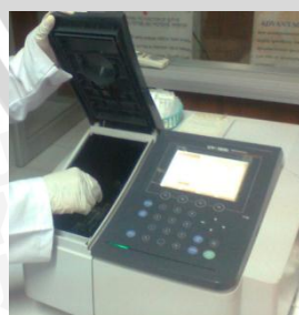
Membaca absorbansi pada panjang gelombang 500nm
