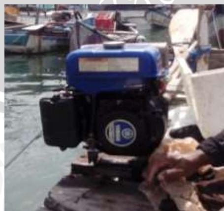
Gambar 4. Mesin Kapal *Trammel net* dengan merk yamaha mz175
