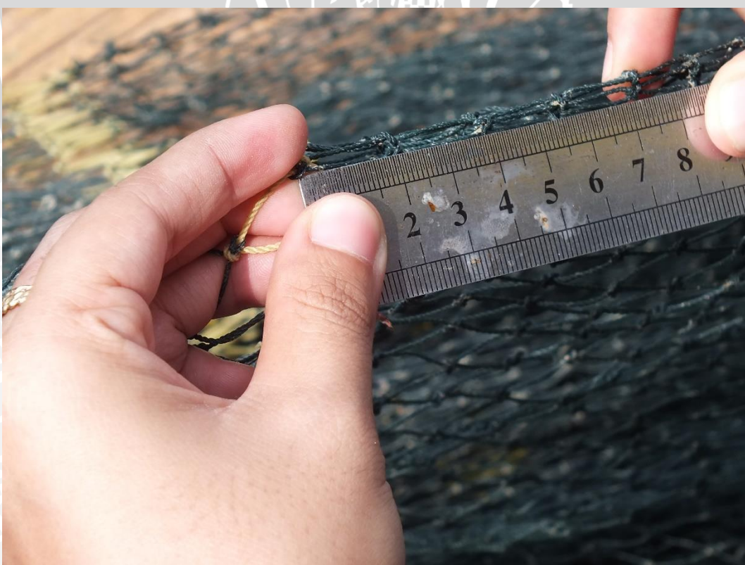
Pengukuran mesh size pada bagian badan cantrang
