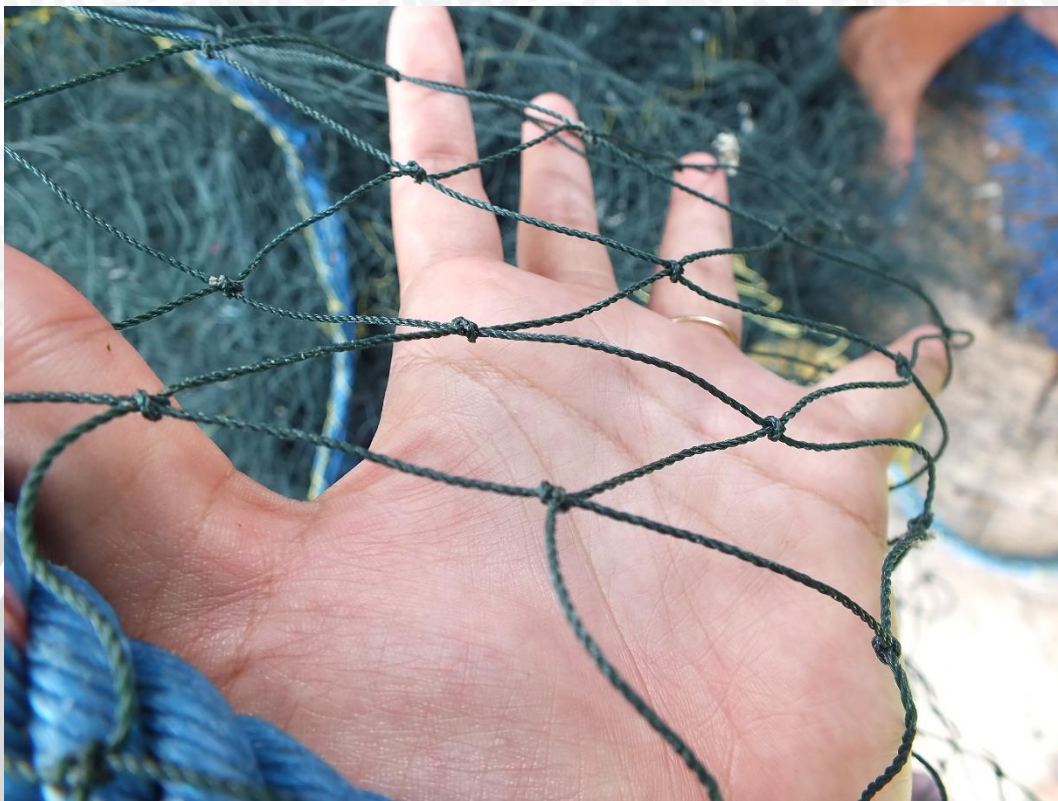
Pengukuran mesh size pada bagian sayap cantrang
