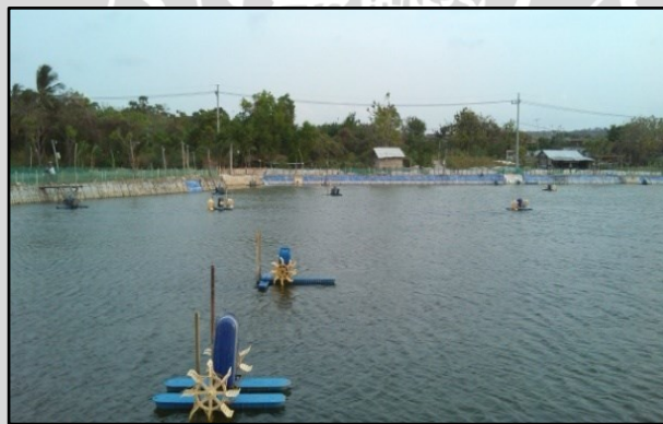
Gambar15. Posisi kincir air saling berhadapan yang bertujuan untuk mengalirkan oksigen keseluruhan tambak dan mengalirkan kotoran kearah tengah atau central .
