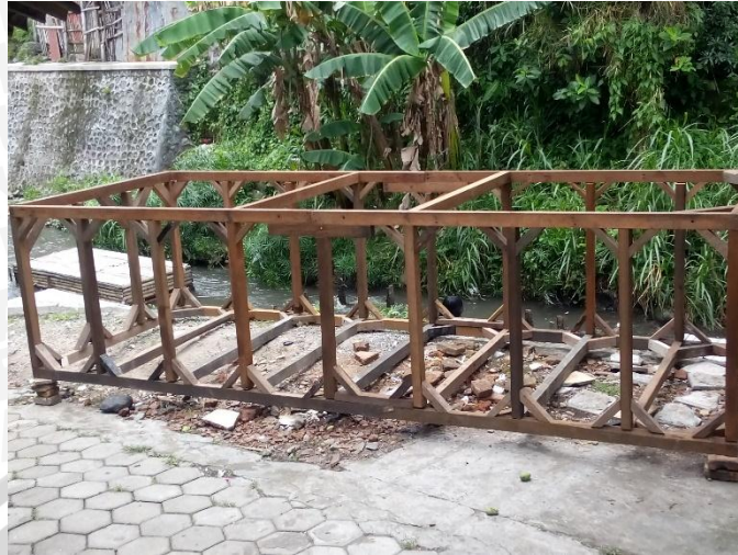
Gambar 5. Kerangka karamba bambu
