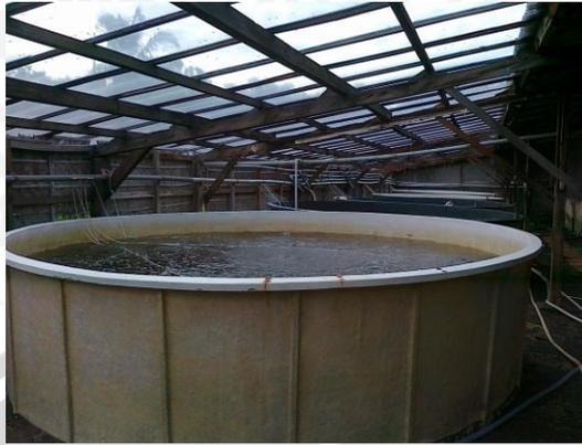
**Gambar 7.** Kontruksi Bak fiber ukuran 10 ton pada Skala Massal
