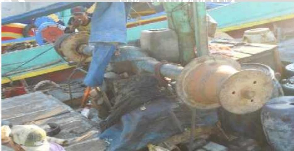
**Gambar 11. Alat Bantu Gardan pada Alat Tangkap Dogol**
