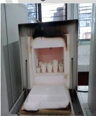
Pengabuan di dalam muffle dengan suhu  $600^{\circ}\text{C}$  selama 3 jam
