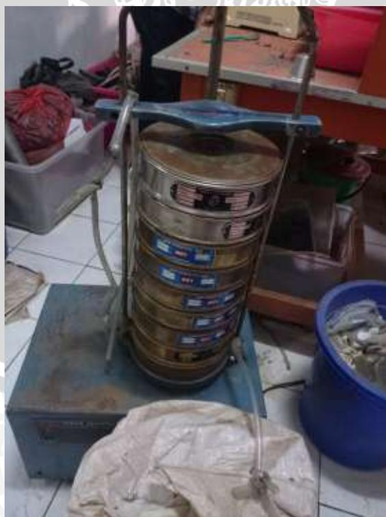
Gambar 31. Pengayakan Sedimen Menggunakan Sieve Shaker
